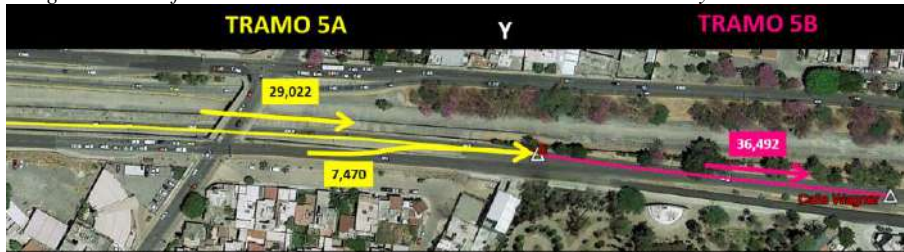
Imagen 38 Identificación de Demanda en TDPA de la Situación sin Proyecto Tramo 5A – 5B.
